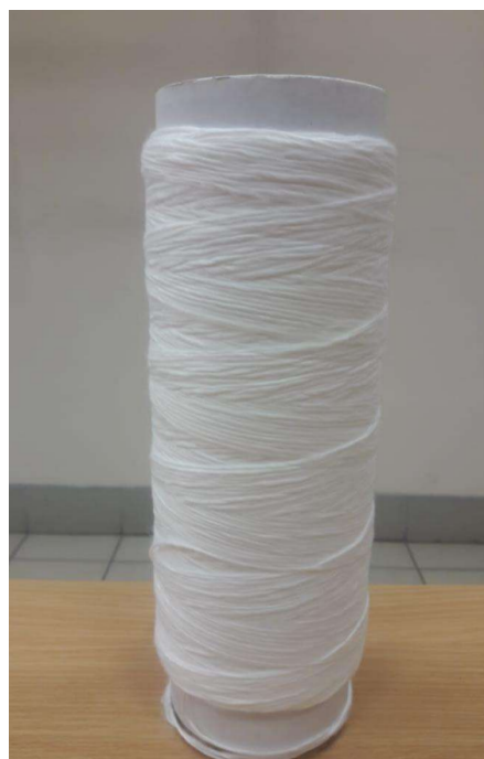
Рисунок 8 Намоточное изделие с сомкнутой структурой намотки, передаточное отношение u = \frac{491}{49}
