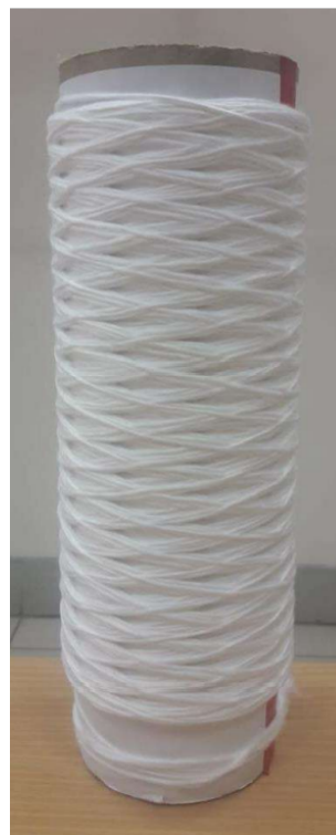
Рисунок 18 Намоточное изделие со спиралевидной опережающей структурой, передаточное отношение u = \frac{1468}{179}
