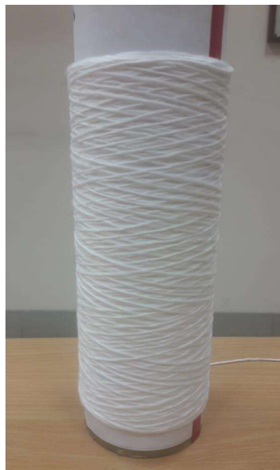
Рисунок 10 Намоточное изделие с сомкнутой структурой намотки, передаточное отношение u = \frac{494}{61}
