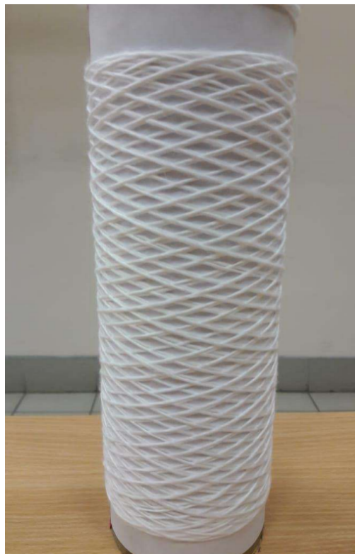
Рисунок 14 Намоточное изделие с сотовой структурой, передаточное отношение u =
