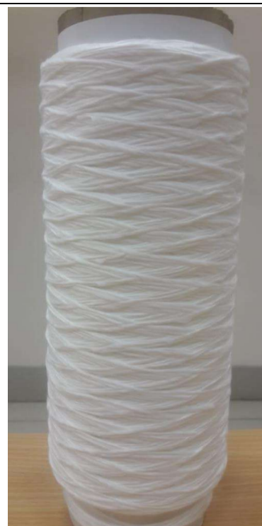
Рисунок 16 Намоточное изделие со спиралевидной структурой, передаточное отношение u = \frac{992}{121}
