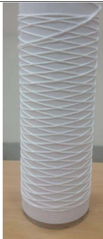
Рисунок 12 Намоточное изделие с сотовой структурой, передаточное отношение u =
